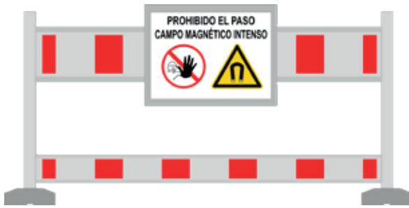
Figura 2. Ejemplo de barrera móvil simple para restringir el acceso a un campo magnético intenso.
