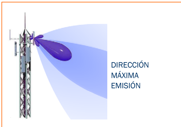
Figura AIII-6. Características de emisión de una antena direccional de telefonía móvil
