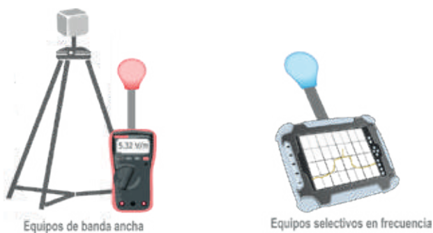
Figura 5. Equipos de medida de CEM.
