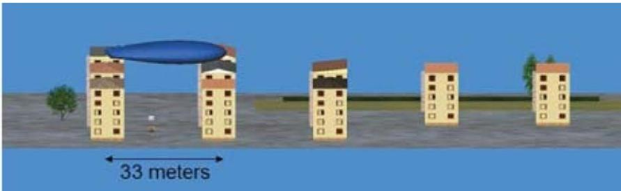
**Figura 5.** La distancia de cumplimiento de una estación base típica montada sobre un techo, calculada para un límite de exposición de 0,6 V/m, es 165 metros en dirección hacia adelante.<sup>5</sup>
